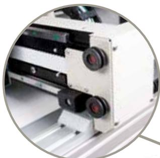
I **sensori di sicurezza ad infrarossi** assicurano la massima protezione in ogni fase della lavorazione. Posizionati frontalmente, mantengono l'operatore completamente protetto sia sulla stazione di sinistra sia su quella di destra.
